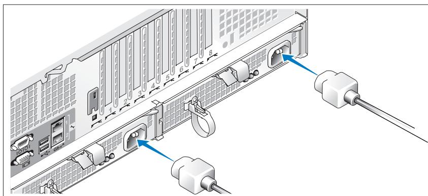
חבר את כבל החשמל של הצג אל הצג (אופציונלי). לחבר את כבלי החשמל של המערכת למערכת. לחבר את הקצה השני של כבלי החשמל לשקע החשמלי מוארך או למקור מתח אחר, כגון מערכת אל-פק (UPS) או ליחידה הולכת מתח (PDU). אם ניתן, לחבר את ספקי הכוח לשני מקורות מתח V110 V220 שונים, או לשני מקורות מתח V220 שונים, בהתאם למקורות המתאימים בהם נעשה שימוש.
