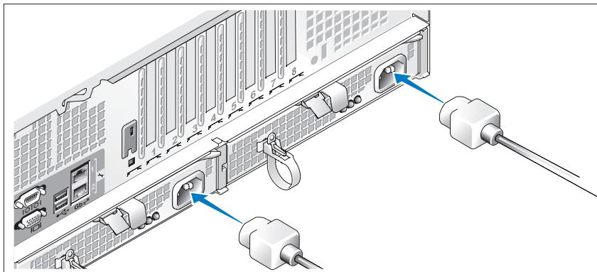
Branchez une extrémité du câble d'alimentation approprié sur le moniteur, si nécessaire. Branchez une extrémité du câble d'alimentation approprié sur le système.
