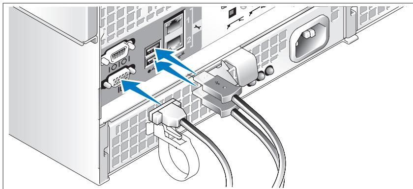
Подключите клавиатуру, мышь и монитор (дополнительно).
