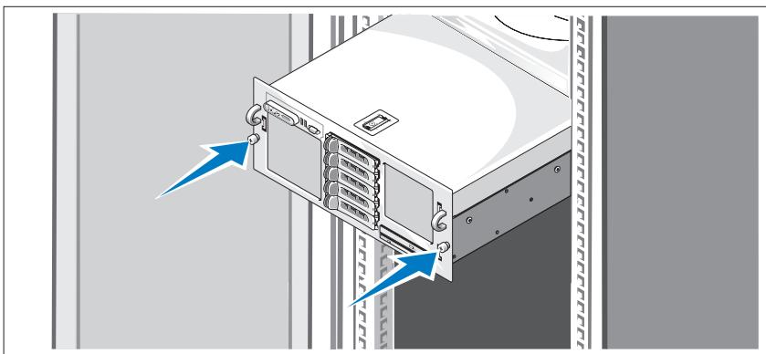
Nejprve si přečtěte Bezpečnostní pokyny uvedené v dokumentaci k instalaci systému do stojanu a potom provedte instalaci systému do stojanu.
