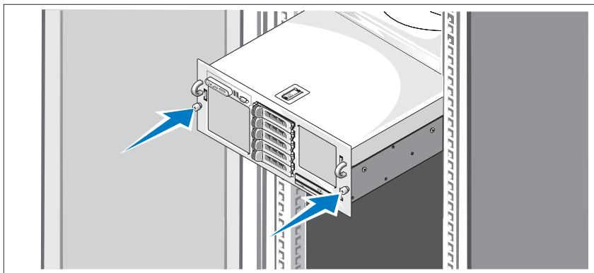
Установите систему в стойку после ознакомления с «Инструкциями по технике безопасности», представленными в документации по установке системы в стойку.
