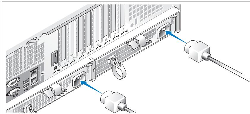
Napájecí kabel monitoru připojte k monitoru (volitelný). Napájecí kabely systému připojte k systému.
