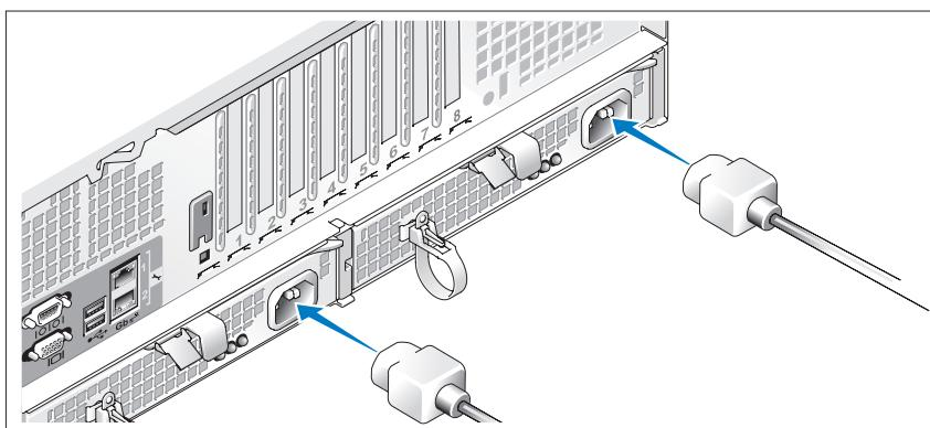
Schließen Sie am Bildschirm (optional) das zugehörige Netzstromkabel an. Verbinden Sie das bzw. die Netzstromkabel mit dem System.
